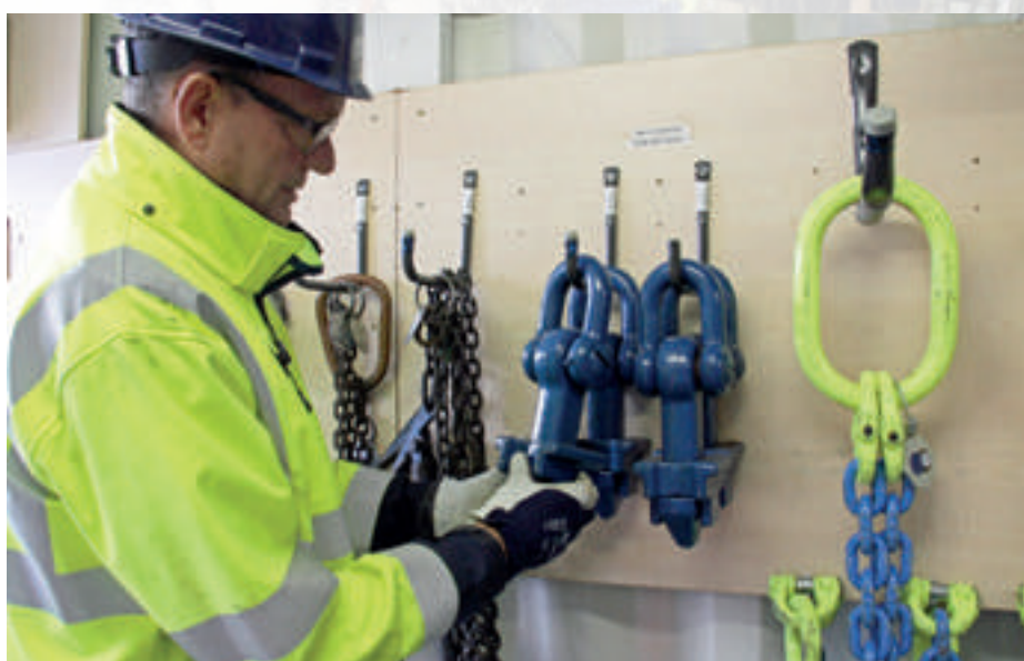
Cock, specialist simulatortraining, bij de twistlocks die dienen voor het vastzetten van containers.
